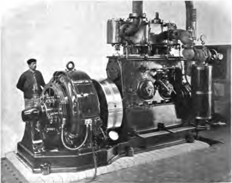
FIG. 147.—100 H.P. ENCLOSED DOUBLE-ACTING COMPOUND HIGH SPEED ENGINE, BY MESSRS. RUSTON, PROCTOR & CO., LTD., LINCOLN.
