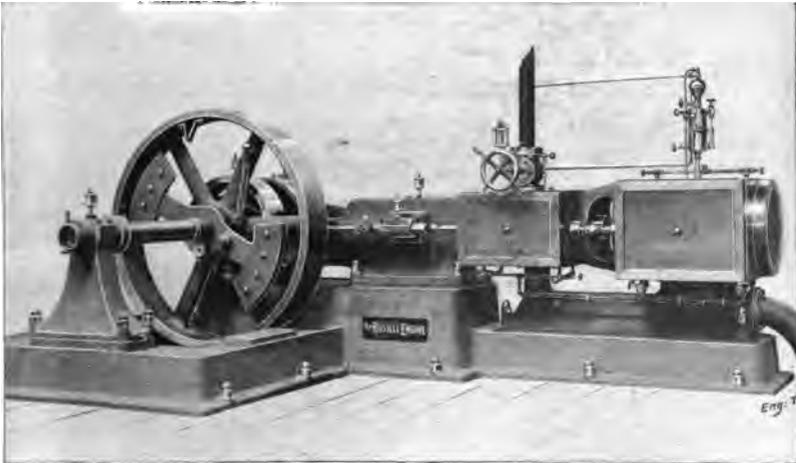
FIG. 105.—THE "RUSSELL" HIGH SPEED TANDEM COMPOUND ENGINE.
