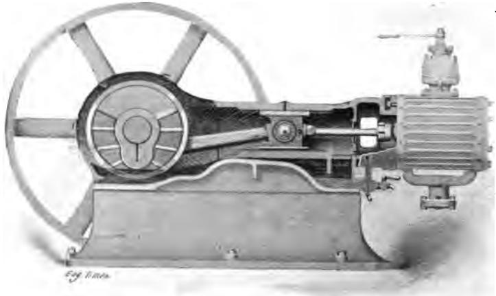
FIG. 90.—"IDEAL" SELF-OILING SYSTEM. A. L. IDE & SONS, SPRINGFIELD, ILL.
