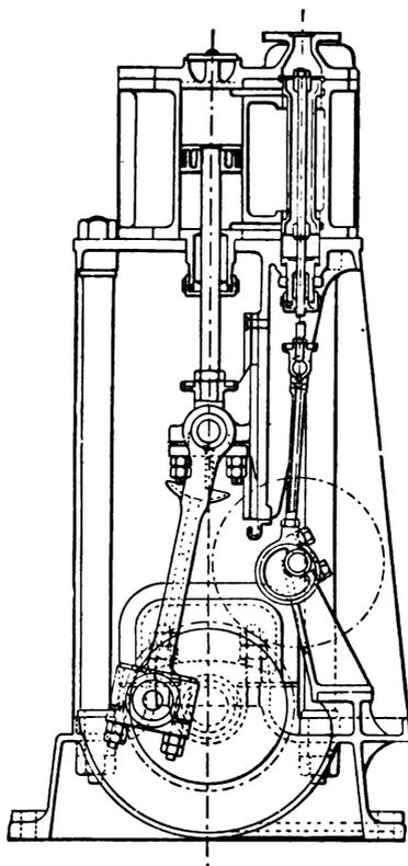
FIG 53.—SECTIONAL VIEW OF COULTHARD'S HIGH SPEED TRIPLE EXPANSION ENGINE.
