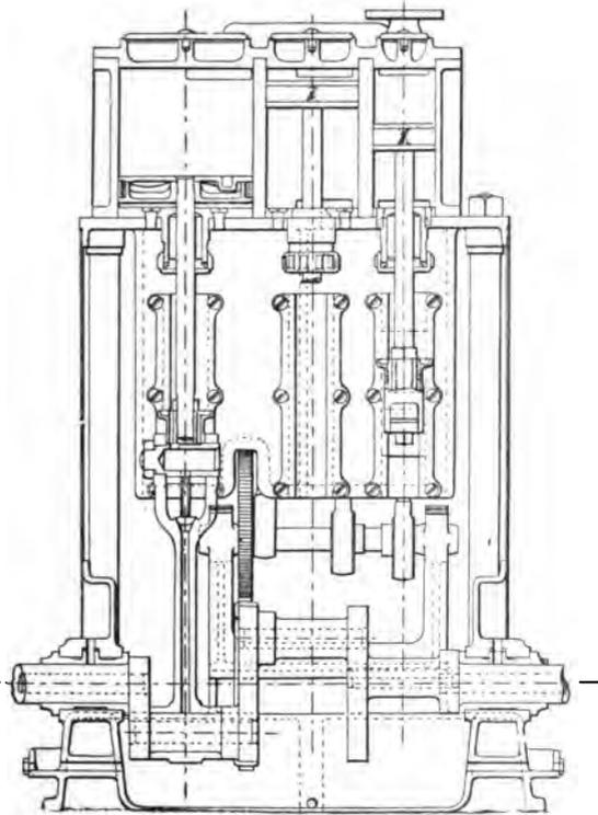
FIG 54.—SECTIONAL VIEW OF COULTHARD'S HIGH SPEED TRIPLE EXPANSION ENGINE.
