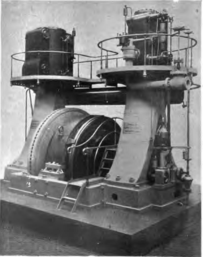
FIG. 117.—700 I.H.P. ENGINE BY MESSRS. GALLOWAYS, LTD., MANCHESTER.
