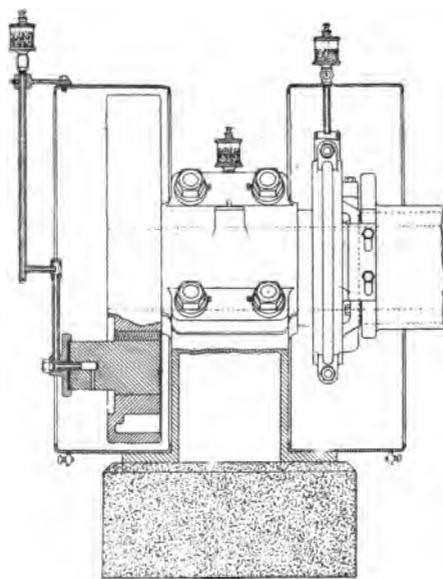
FIG. 102.—"RUSSELL" ENGINE—SHOWING ARRANGEMENT OF OIL GUARDS.
