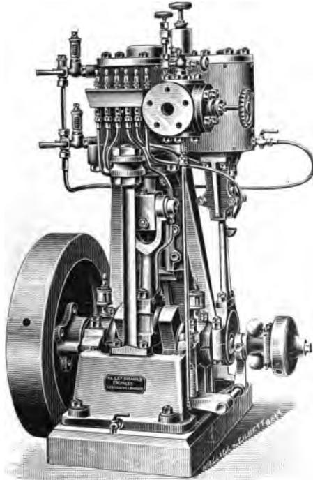
FIG. 77—SINGLE CYLINDER HIGH SPEED ENGINE BY MESSRS. ALEX. SHANKS & SON.
