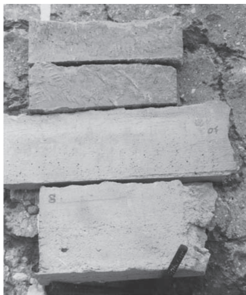
Figura 8. Muestras de yeso envejecido artificialmente.
