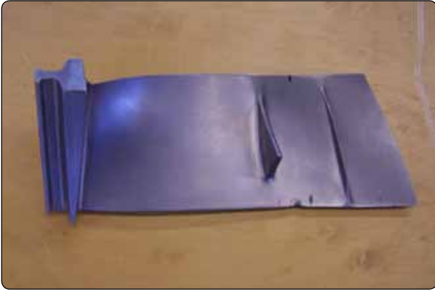
Figure 10-59. Fan blade damage.
