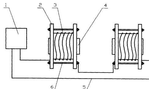
1、一种高压脉冲稳恒磁场种子仪，包括高压脉冲磁场发生装置[1]，其特征是高压脉冲磁场发生装置[1]的正、负极输出端分别通过电源线[5]接有两个结构相同、大小一致并且它们内侧中部位置之间可形成均匀磁场的赫姆霍兹线圈[3]。
