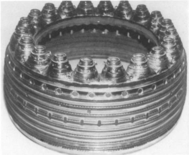
**Fig. 2.7** JT9D annular combustor.
